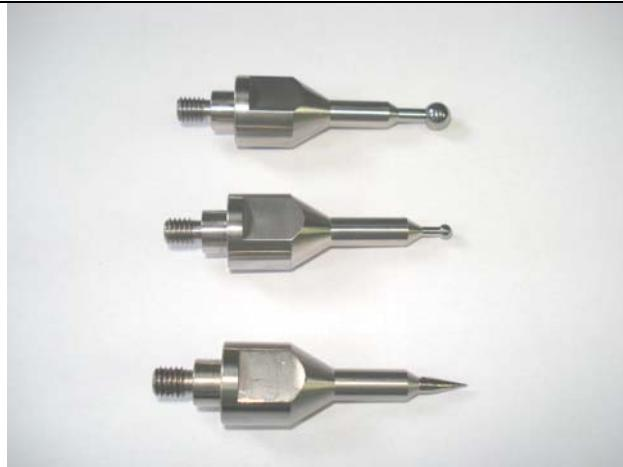
Veja ao lado como fica a ponta montada no braço PLATINUM, com adaptador e ponta M6 - esfera de Ø 6,35mm
